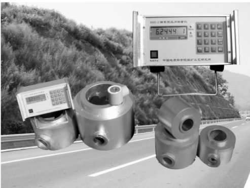
BMS-2 读数表与数字式锚索预应力传感器配合可以进行人工手动测量
