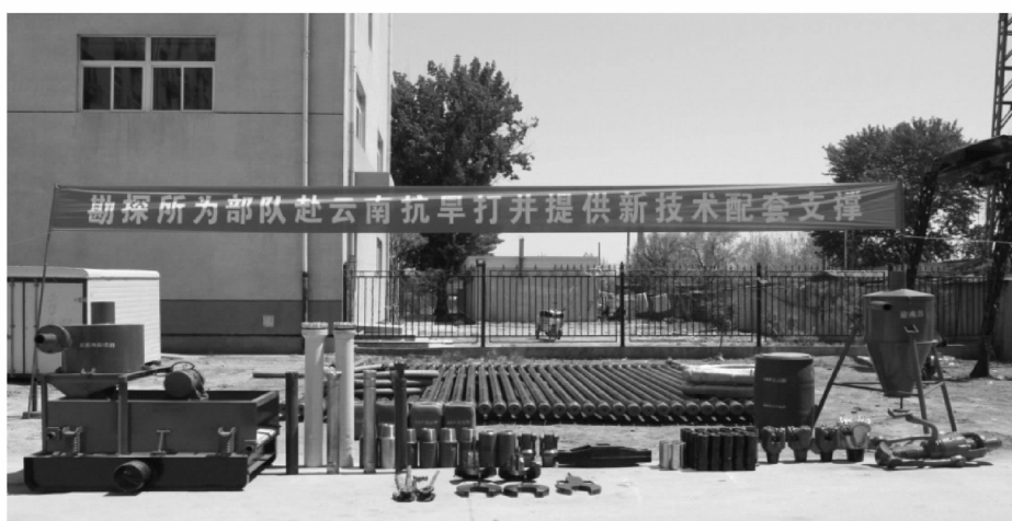
图5 为北京军区给水团抗旱打井配套中空式反循环气动潜孔锤钻探器具
