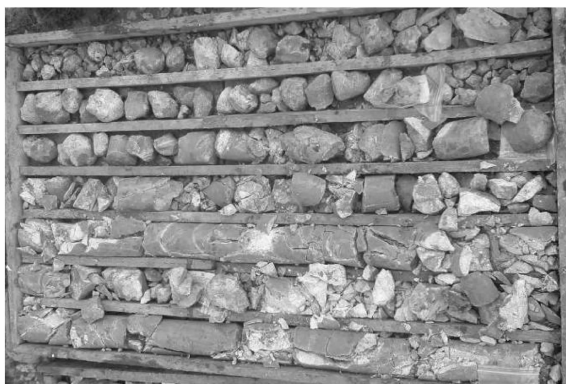
图 5 半隔液 PDC 钻头取心效果
