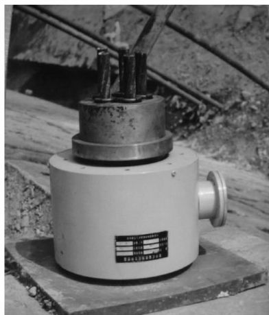
安装完毕用于长期监测的锚索 预应力传感器
