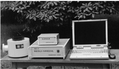
MS-1 型锚索预应力测量系统可以进行锚索预应力的自动测量、记录与数据传输
