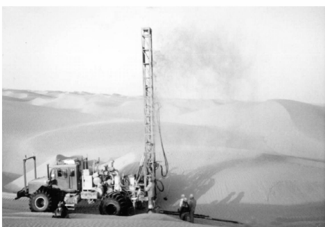
图2 反循环物探爆破孔施工技术在新疆施工现场
