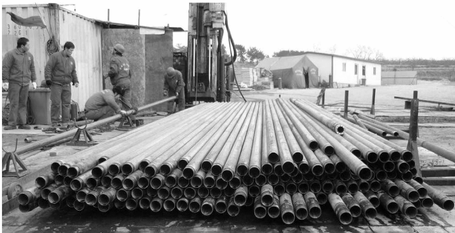
图 1 高强度绳索取心钻杆现场使用情况
