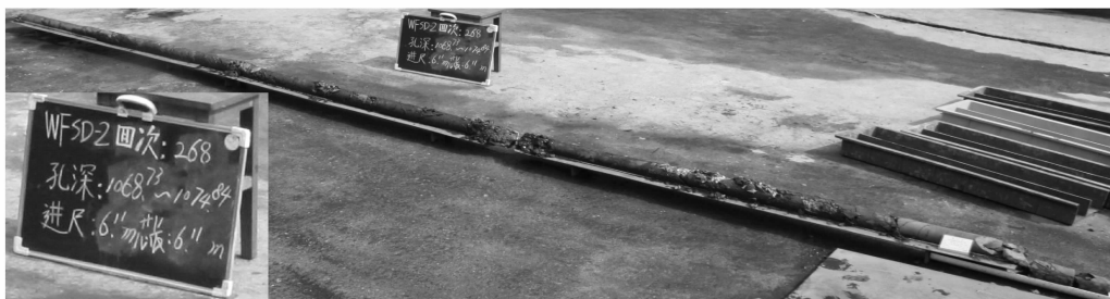
图 4 6 m 长半合管在 WFSD-2 孔取心效果
