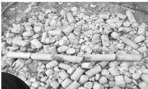
图1 从钻孔内取出“固结岩心”
