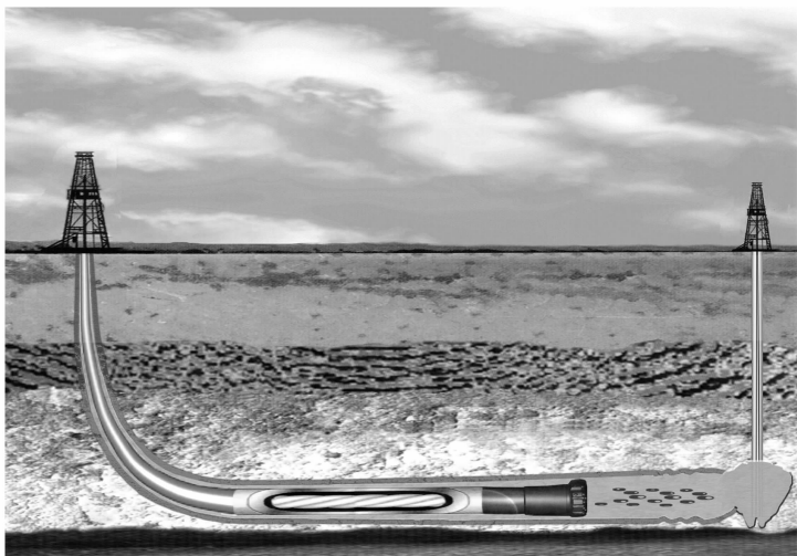
图2 对接连通井采矿示意图
