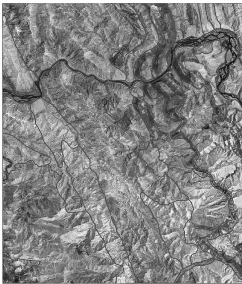
图3 基于 MNF 变换的岩性提取
